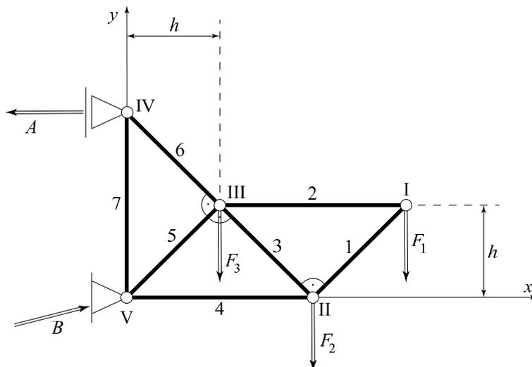
Die drei Lasten  $F_1, F_2, F_3$  rufen in jedem Stabende eine Reaktionskraft parallel zum Stab hervor. Die Reaktionskräfte in den Lagern (IV) und (V) sind die Vektoren  $(-A, 0)^T$  respektive  $(B_x, B_y)^T$ . Im statischen Gleichgewicht gelten die beiden Regeln:
