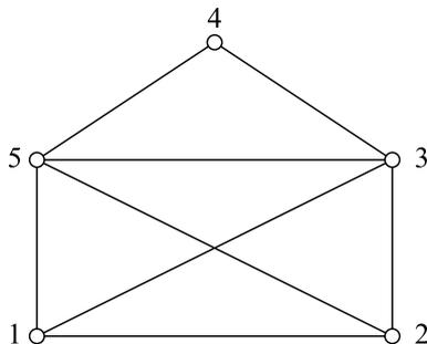
aus Serie 10, Aufgabe 4 als elektrisches Netzwerk, wobei jede Kante einem Widerstand von  $R_0 = 1 \Omega$  entspricht. Berechnen Sie den Widerstand  $R$  zwischen den Knoten 1 und 5 mit Hilfe der Formel  $R = R_0 \frac{\tau_{15}}{\tau}$ , wobei  $\tau$  die Anzahl der aufspannenden Bäume von  $G$  ist und  $\tau_{15}$  die Anzahl der aufspannenden Teilbäume, welche die Kante zwischen den Knoten 1 und 5 enthalten. Verwenden Sie dazu die Formel aus Serie 10, Aufgabe 4.
