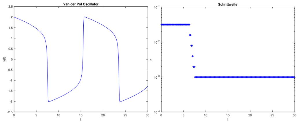
Abbildung 1 – Lösung  $y(t)$  links und Schrittweite  $h$  rechts.
