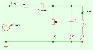
Der Plan zeigt eine Schaltung bestehend aus einer Standarddiode (D 1N4148), sowie Widerstand R, Kapazität (Kondensator) C und Induktivität (Spule) L. Eingezeichnet sind auch die Messpunkte  $V_{in}$  und  $V_{out}$  für Spannungen sowie  $I_{in}$ ,  $I_R$ ,  $I_C$  und  $I_L$  für Ströme. Die Schaltung ist an eine Wechselspannungsquelle (AC) mit  $V_{in}(t)$  angeschlossen. Gesucht ist die Ausgangsspannung  $V_{out}(t)$  relativ zur Erdung.
