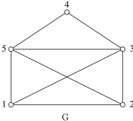
aus Serie 10, Aufgabe 4 als elektrisches Netzwerk, wobei jede Kante einem Widerstand von  $R_0 = 1\Omega$  entspricht. Berechnen Sie den Widerstand  $R$  zwischen den Knoten 1 und 5 mit Hilfe der Formel
