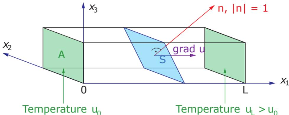
Die Wärmemenge, die sich pro Zeiteinheit durch den Stab der Länge  $L$  von rechts nach links bewegt, ist proportional zur Querschnittsfläche  $A$  und zur Temperaturdifferenz  $u_L - u_0$ , und ist invers proportional zu  $L$ .
