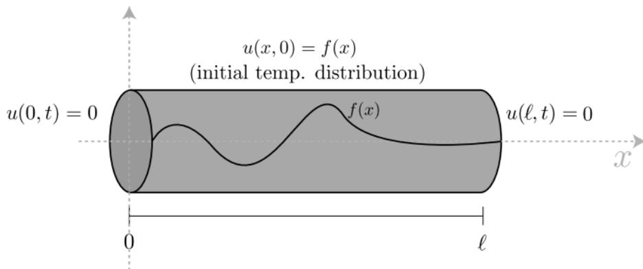
**Abbildung 1.1:** Idealisierte und vereinfachte Darstellung der Wärmeleitung in einem Stab mit homogenen Randbedingungen. Quelle: [https://upload.wikimedia.org/wikipedia/commons/9/97/Temp\\_Rod\\_homobc.svg](https://upload.wikimedia.org/wikipedia/commons/9/97/Temp_Rod_homobc.svg)
