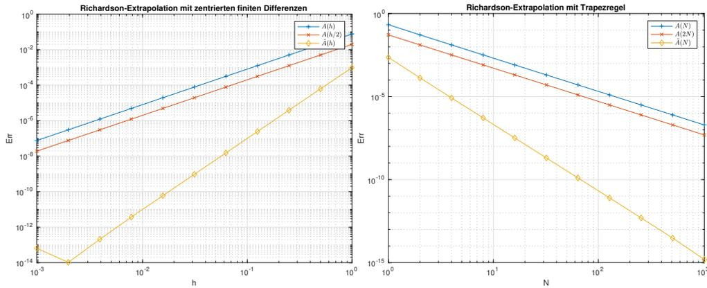
Abbildung 3: Richardson-Extrapolation angewendet auf zentrierte finite Differenzen (links) und die summierte Trapezregel (rechts).
