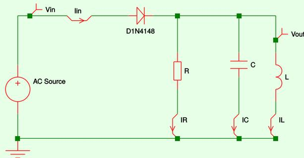
Der Plan zeigt eine Schaltung bestehend aus einer Standarddiode (D 1N4148), sowie Widerstand  $R$ , Kapazität (Kondensator)  $C$  und Induktivität (Spule)  $L$ . Eingezeichnet sind auch die Messpunkte  $V_{in}$  und  $V_{out}$  für Spannungen sowie  $I_{in}$ ,  $I_R$ ,  $I_C$  und  $I_L$  für Ströme. Die Schaltung ist an eine Wechselspannungsquelle (AC) mit  $V_{in}(t)$  angeschlossen. Gesucht ist die Ausgangsspannung  $V_{out}(t)$  relativ zur Erdung.
