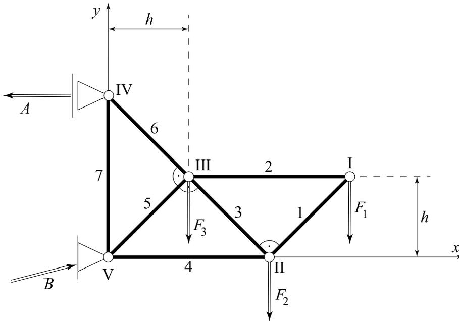
Die drei Lasten  $F_1, F_2, F_3$  rufen in jedem Stabende eine Reaktionskraft parallel zum Stab hervor. Die Reaktionskräfte in den Lagern (IV) und (V) sind die Vektoren  $(-A, 0)^\top$  respektive  $(B_x, B_y)^\top$ . Im statischen Gleichgewicht gelten die beiden Regeln:
